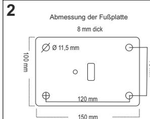
2 Fußplatten für Auflagepfosten
